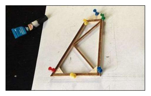
После высыхания клея каркас усиливается внутренними уголками из бальсы.
