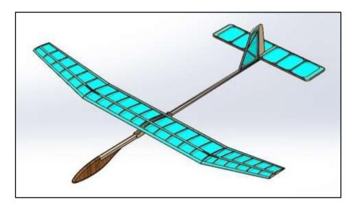
Эту операцию нужно проводить с тщательным контролем взаимной перпендикулярности элементов оперения и ровностью положения стабилизатора относительно балки фюзеляжа при виде сверху.
