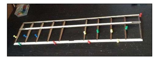
После сборки каркаса кромки состругиваются по профилю крыла и закругляются.
