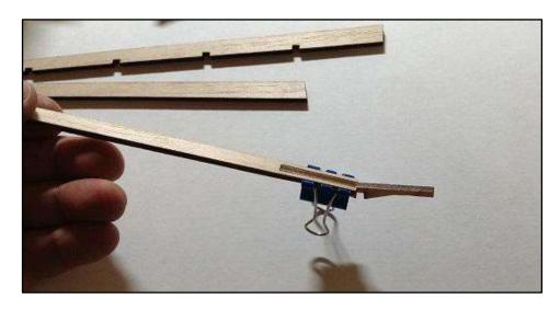
Собираем конструкцию «насухо» на чертеже и проливаем стыки клеем.
