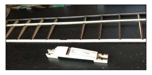
Вклеиваем центроплан строго посередине в соответствующие пазы передней и задней реек
