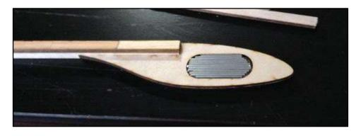
Свинцовый или металлический балансировочный груз вставляется в отверстие носика и заклеивается сверху фанерной накладкой.
