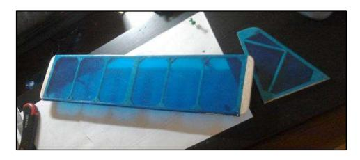
1.4.1. СБОРКА ЦЕНТРАЛЬНОЙ СЕКЦИИ КРЫЛА
