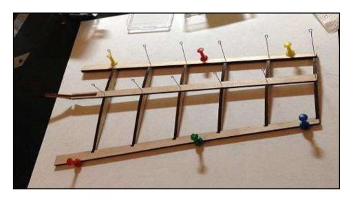
Собираем вторую концевую секцию крыла зеркально аналогично предыдущей. После высыхания клея собираем крыло на клей на ровной поверхности не допуская перекосов.
