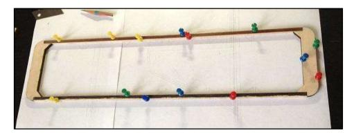
Передняя и задняя кромки каркаса стабилизатора закругляются.
