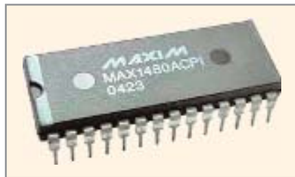
Рис. 2. Специализированная микросхема интерфейса RS-485
